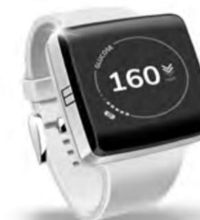
Photo : K'Watch est une montre connectée qui permet de monitorer le taux de glucose
